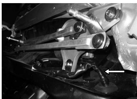
8. 取出雨刮控制机构总成。
