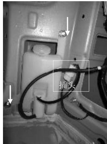
4. 在直通接头处，取下导水管，拿出后洗涤器总成。
