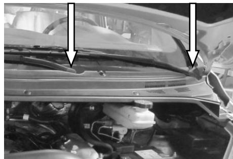
2. 拧下雨刮臂固定螺母{六角法兰面锁紧螺母(Q32010), M10
