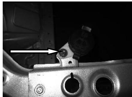
3. 拆下洗涤器的固定螺栓（M6）。
