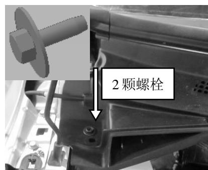
6. 松开雨刮连杆控制机构的固定螺栓{六角组合螺栓(MD161216)，标准扭矩为 9N.m}。
