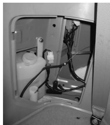
2. 拆下左后柱护板。
