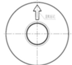
**安装：**按拆卸程序的相反顺序安装。装后雨刮玻璃橡胶密封圈时，注意要保证箭头标志向上。
