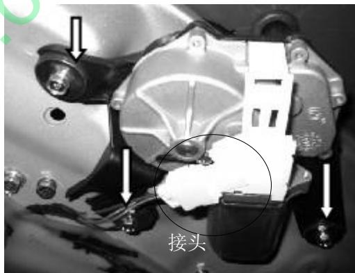
5. 取下后雨刮电机，取出后雨刮玻璃橡胶密封圈（箭头标志向上）。
